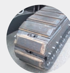
鉄クローラーに ecoYパッド装着状態
